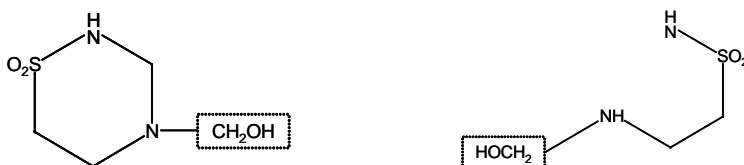
Bild 1.3 Strukturformeln von Hydroxymethyl-Taurultam (links) und Hydroxymethyl-Taurinamid (rechts). Die reaktiven Hydroxymethyl-Gruppen sind gepunktet umrandet.
