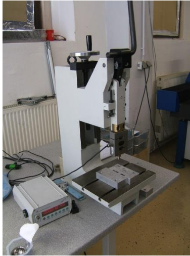
Abbildung 2.3.1: Gechter Handkniehebelpresse zur manuellen Bedienung, Presskraft bis 32 kN, fester Tisch.
