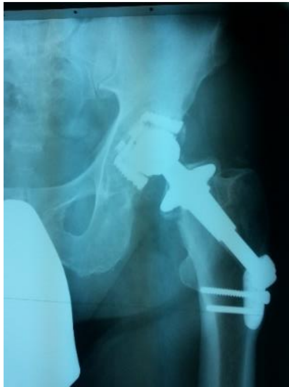
Abbildung 1.1: Röntgenbild einer Druckscheibenprothese mit Balgrist-Spreizpfanne. Nach 8 Jahren Standzeit Riss der äußeren Spreizhülle mit Lockerung der Pfanne, so dass eine Revisionsoperation notwendig wurde.
