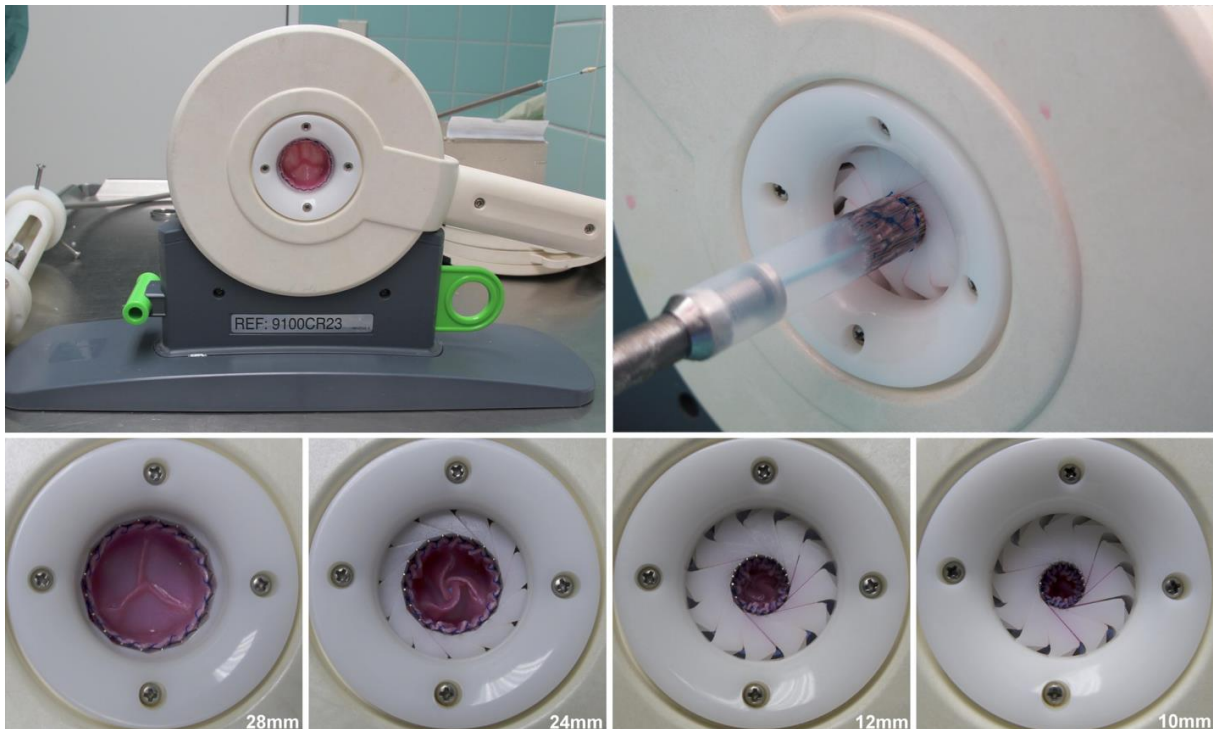
Abbildung 5: Crimping. Oben links: Crimping-Gerät mit Klappenstent in der Übersicht, oben rechts: Einschieben des gecrimpten Stents in den Katheter, unten: Crimpingablauf. Der 30mm im Durchmesser betragende Stent wurde langsam auf eine Endgröße von 8 oder 10mm gecrimpt um ihn nachfolgend in das Ablagesystem einschieben zu können. Die Abbildung stellt verschiedene Stufen des Crimpings dar. Die Millimeterangabe am unteren Bildrand gibt den Außendurchmesser des Stents zum jeweiligen Zeitpunkt an.
