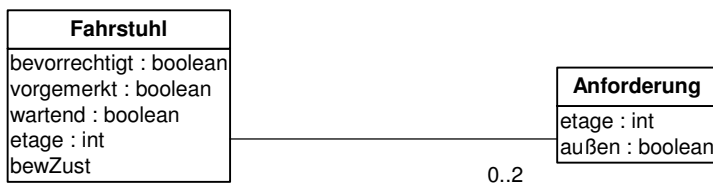
Abbildung 11: UML-Klassendiagramm für den internen Zustand eines Fahrstuhls
