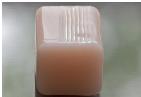
Abb. 5.84: Foto Keramikblock nach Politur mit Rillen
