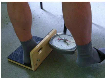
**Abbildung 6:** Isokinetisches Kraftmessgerät zur Bestimmung der Abduktionskraft des Hüftgelenks.
