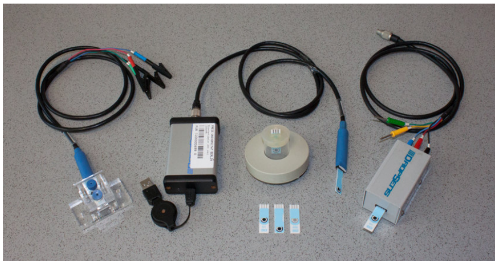
Abbildung 1.1.: Voltammetrie-Messsystem von DROPSSENS mit Zubehör. – Durchflusszelle mit Verbindungskabel DRP-CAC, \mu STAT 200 mit USB-Adapter und Verbindungskabel DRP-CAST, Messzelle mit Standring, Elektrodenstreifen DRP-110, DRP-C110 und DRP-550, Elektrodenadapter DRP-DSC von links nach rechts.
