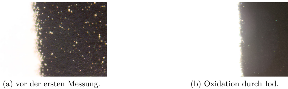
Abbildung 3.14.: Mikroskopische Vergrößerung der Silber-Elektrode nach Oxidation (DRP-550).
