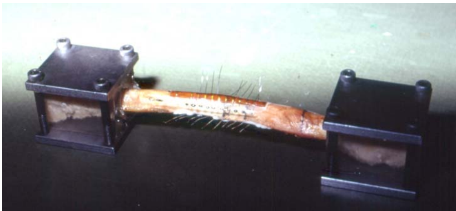
Abbildung 7: Ein mit Dehnungsmessstreifen-Ketten beklebter und in die zusätzlichen Lager aus Metall montierter standardisierter Knochen.
