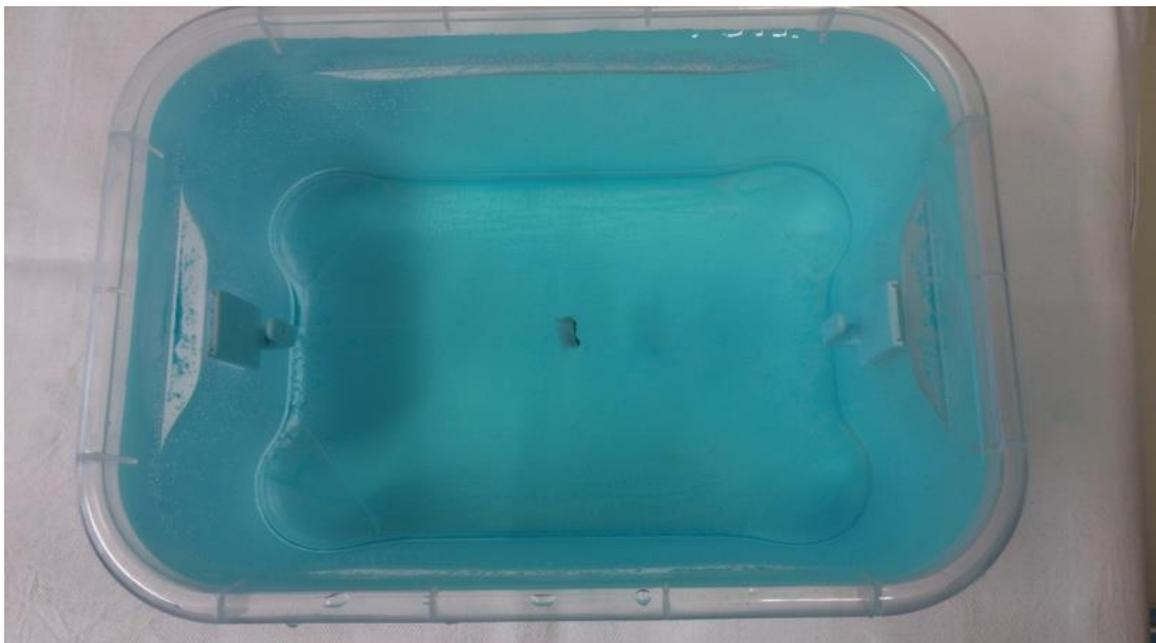
Abb. 7: Testobjekt mittig im Versuchsbehälter mit Kupfersulfatlösung.
