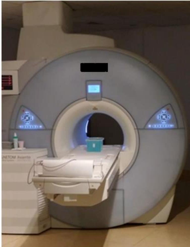
Abb. 12: Testobjekt im Versuchsbehälter mit Kupfersulfatlösung, Messungen im MRT, 1,5-Tesla Magnetresonanztomografen (Siemens Avanto®, Siemens, München).
