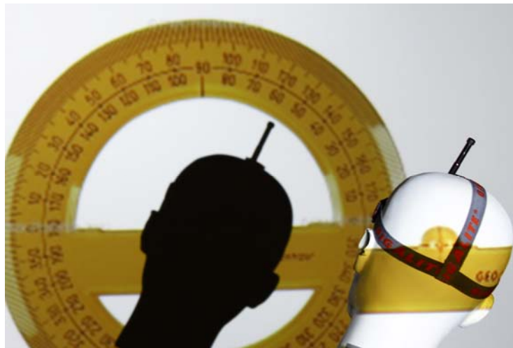
Abb. 10: Messung des Bewegungsumfangs mittels Projektion auf Winkelmesser
