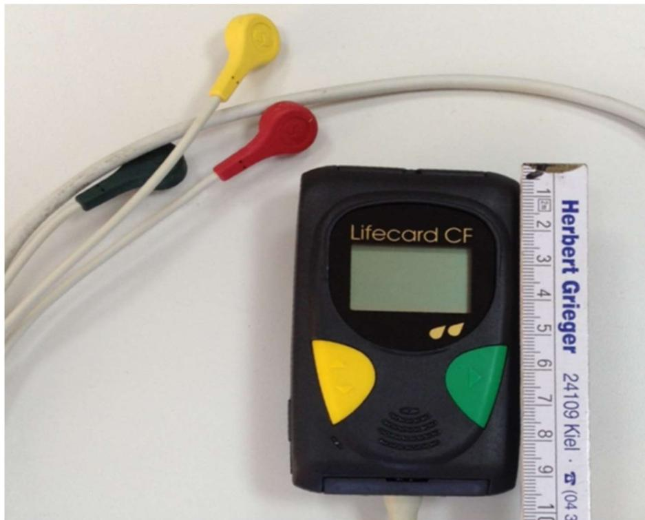
**Abb. 19: Eines der kleinen Langzeit-EKG-Geräte mit denen während der Tauchgänge EKGs abgeleitet wurden. Anhand des Zollstockes lässt sich die geringe Größe der Geräte gut erkennen.**
