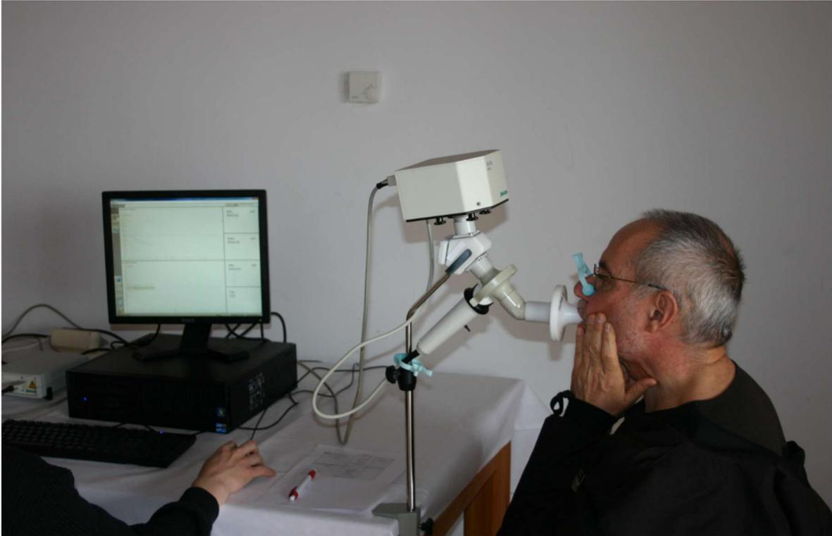
**Abb. 11: Proband bei der Impulsoszillometrie. Die Hände müssen fest auf den Wangen aufliegen, damit diese nicht mitschwingen. Der Messkopf ist in der richtigen Höhe montiert, um dem Probanden eine entspannte Ruheatmung zu ermöglichen. Dieses Messgerät wurde mit Hilfe spezieller Software auch als Spirometer verwendet.**
