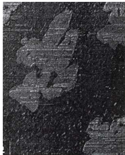
Abb. 6.3.8: RTM-Bild der Cu/Ru(0001)-Oberfläche nach Deposition von \Theta_{\text{Cu}} < 0,5 ML bei RT ( 700 \text{ \AA} \times 700 \text{ \AA} , I = 1,6 \text{ nA} , U = 20 \text{ mV} ) [PÖT91/1]
