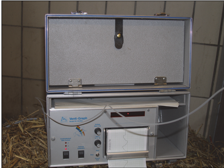
Abb. 2: Auswahl des günstigsten Druckmessbereiches anhand der Leuchtdiodenanzeige.
