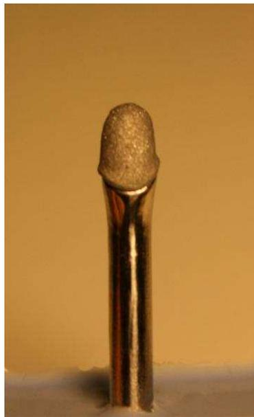
**Abbildung 12: Metallgerüst auf Stumpf**
