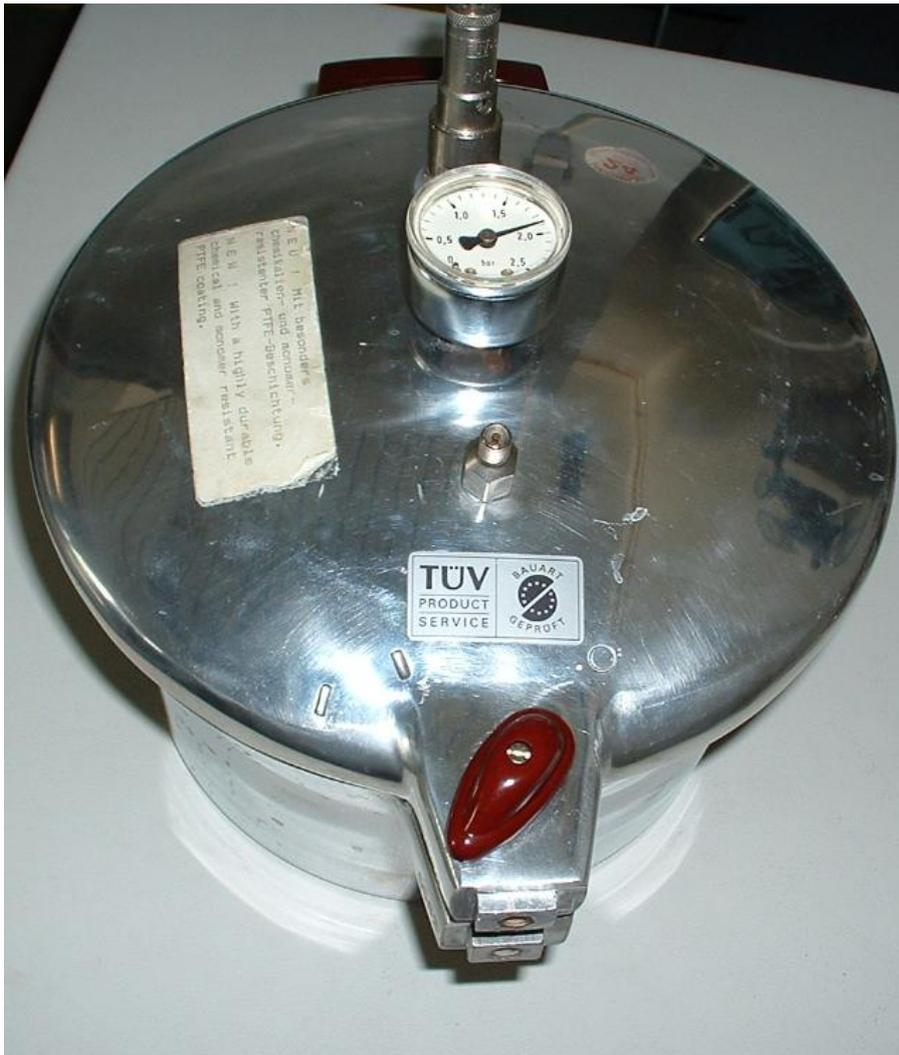
Abbildung 4: Handelsüblicher Schnellkochtopf mit Manometer und zusätzlichem Ventil, in dem der notwendige Sauerstoffdruck gehalten und kontrolliert werden konnte.
