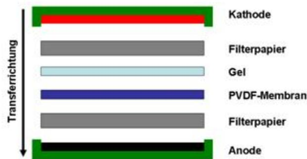
**Abb. 4.1: Aufbau eines Western Blots:** Direkt auf der Anode werden vier in Anodenpuffer I getränkte Whatman-Papiere angeordnet. Es folgen zwei in Anodenpuffer II getränkte Whatman-Papiere. Nun folgen die in Methanol aktivierte PVDF-Membran, das SDS-Gel sowie sechs in Kathodenpuffer getränkte Whatman-Papiere. Die Kathode schließt den Western Blot ab [Eisenreich, 2009].
