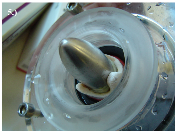
Abb.8 (1 - 6) Vermessung und Präparation einer Schweineklappe vor (1 - 5) und während der Installation im HKP+(6)
