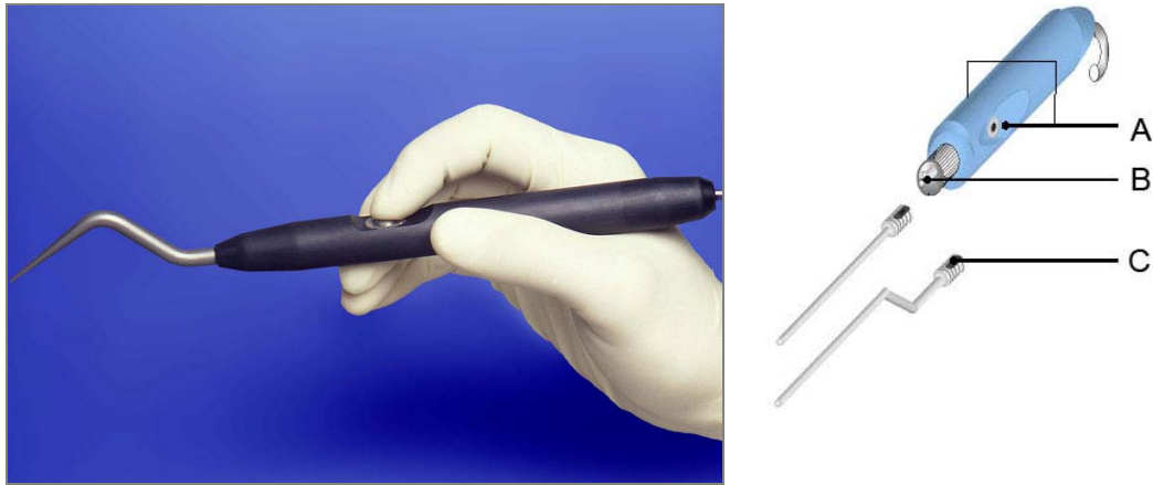
Abbildung 3.5: Sensor-tragender „Stylus“ mit (A) Funktionstaste und (B) Ansatz für austauschbare Spitzen (C).
