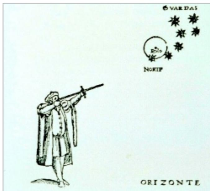
Abbildung 2.3: Antike Zeichnung über die Anwendung eines Jakobsstabs.
