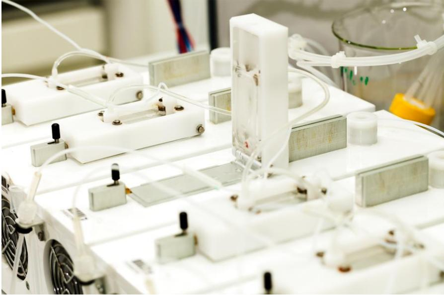
**Abbildung 19 Automatische Hybridisierstation zur Slideinkubation**
