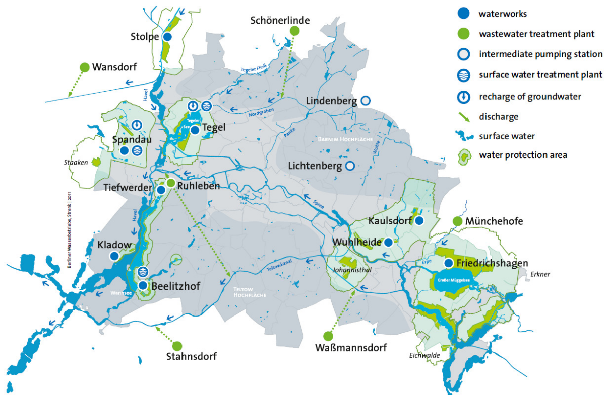
Fig. 1.4: Berlin's water supply system (BERLINER WASSERBETRIEBE 2014).
