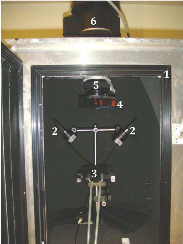
Abb. 9: Versuchsaufbau 1) Dunkelkammer 2) Laserlicht 3) Maushalterung 4) Filtersystem 5) Objektiv 6) Kamera
