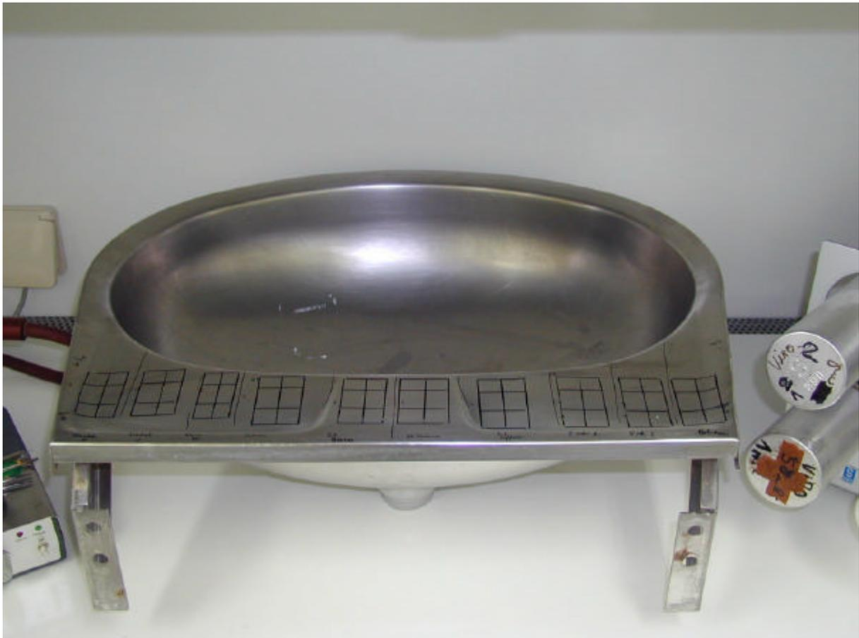
Abb. 44: Versuchsaufbau der Virusrückgewinnung von einer Edelstahloberfläche
