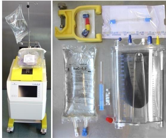
Abbildung 4: Cell-Saver-System mit Zubehör
