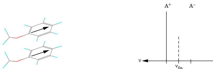
Abbildung A.2: Strukturvorschlag für das Anisol-Dimer ( \Theta = 0^\circ ) und das resultierende Absorptionsspektrum.
