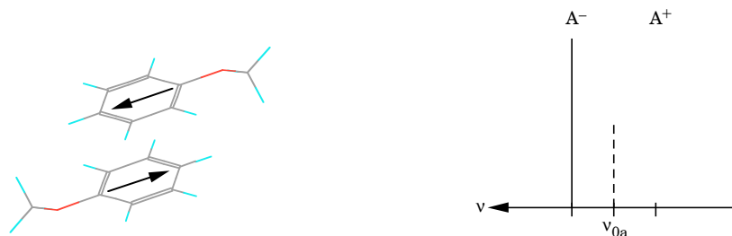
Abbildung A.4: Strukturvorschlag für das Anisol-Dimer ( \Theta = 180^\circ ) und das resultierende Absorptionsspektrum.
