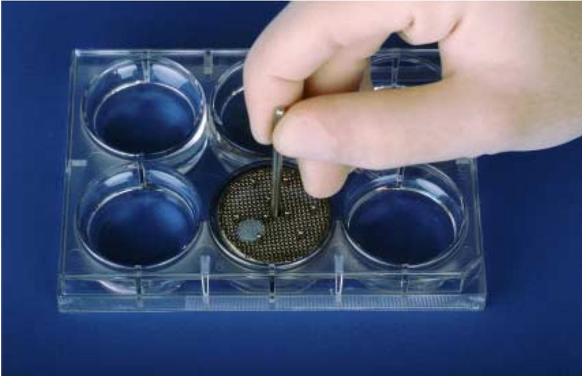
**Abbildung 7** Einschleusung des Vitrifikationsmediums; mit Hilfe eines Siebspatels wird die Hornhautlamelle auf den Lamellenträger gelegt; der Lamellenträger ermöglicht das Eintauchen der Hornhautlamellen in die unterschiedlich konzentrierten Vitrifikationslösungen unter Vermeidung einer mechanischen Belastung (zur besseren Anschaulichkeit wurde für die Demonstration eine getriebte Hornhautlamelle verwendet).
