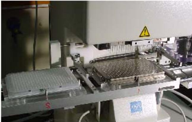
**Abbildung 10** Übertragung der Proben von einer MTP auf den MALDI-Probenträger.
