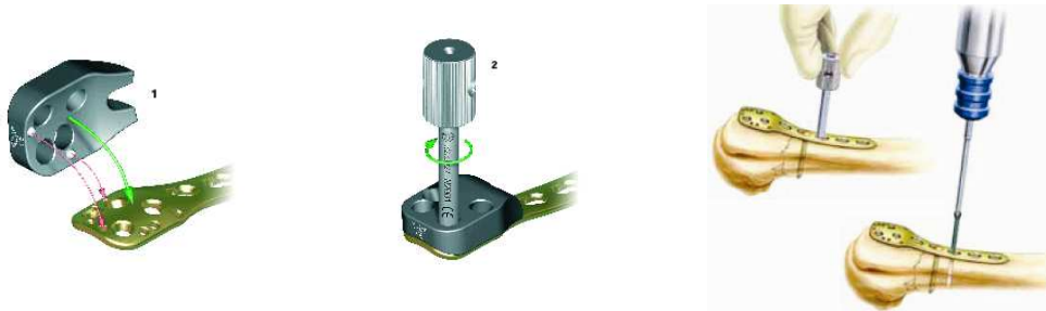
Abb.2.1 1 Zielblock 2 Einschrauben der LCP-Führungsbüchse 3 Führungsbüchse im Schaftbereich und drehmomentbegrenzender Aufsatz
