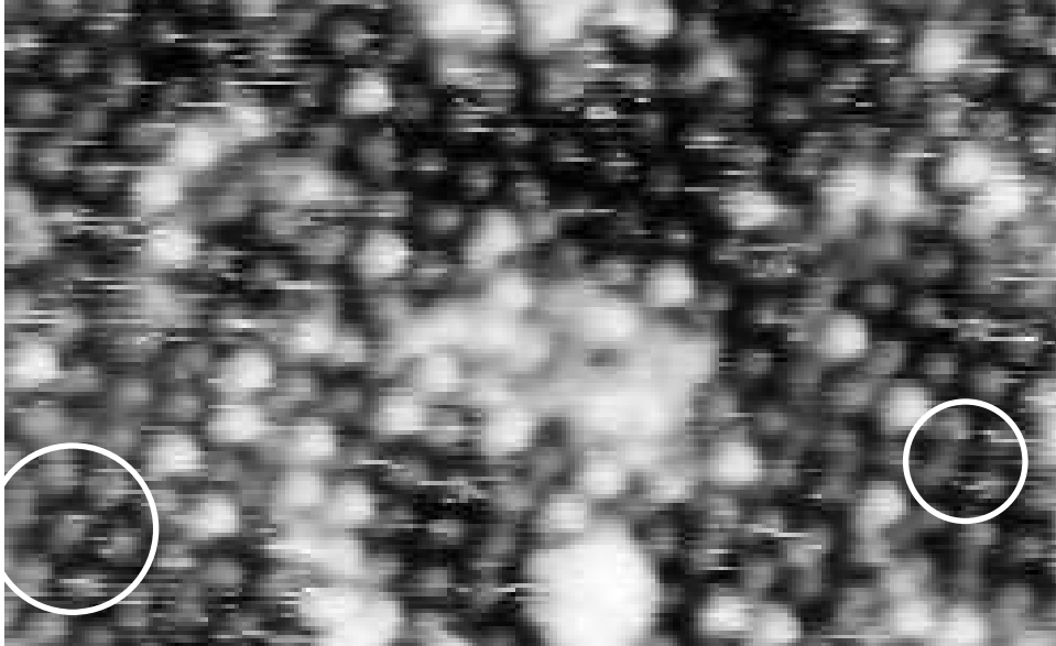
Abbildung 6.8: STM-Bild der RuO 2 (110)-Oberfläche bei einem Sauerstoffdruck von 200 mbar (80 Å × 130 Å, 0.4 V, 0.8 nA). Die heller abgebildeten Atome machen einen Anteil von ca. 22% aus. Durch weiße Kreise kenntlich gemacht ist ein Bereich mit lokaler c(2 \times 2) -Struktur (links) und ein Bereich mit lokaler (2 \times 1) -Struktur (rechts).
