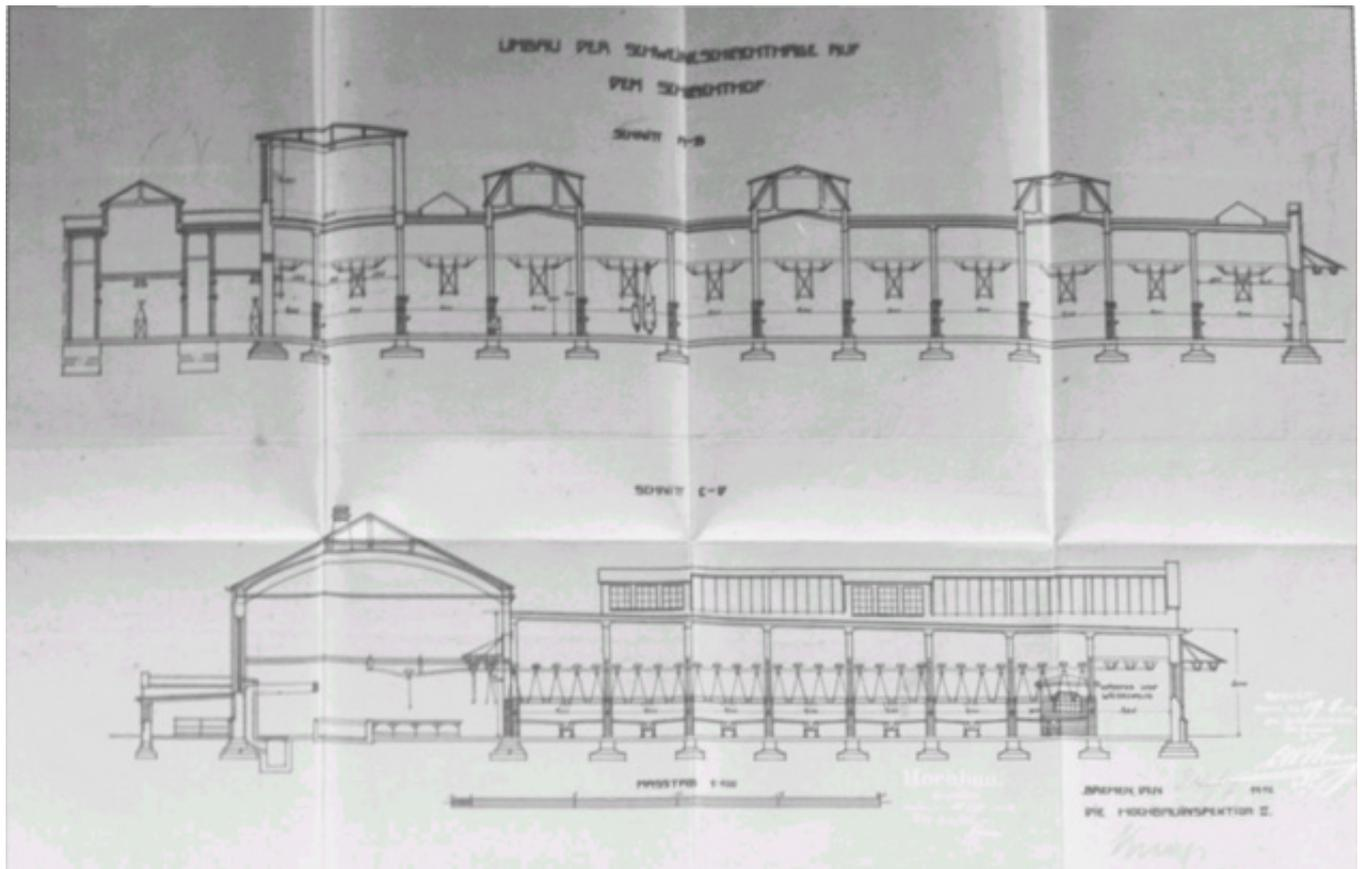
Abb. 10: Bauplan des Umbaus der alten Schweineschlachthalle (Dat. unbek.)
