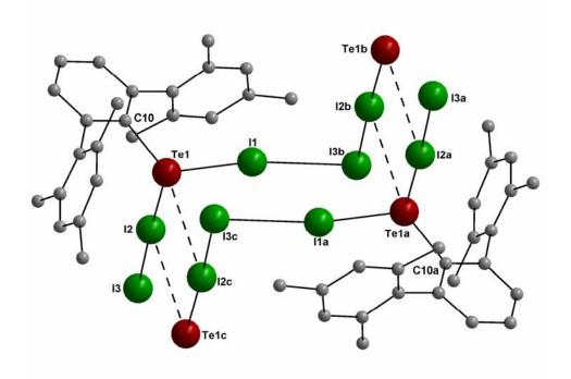
Abbildung 23: Ausschnitt der Molekülstruktur von **14**.
