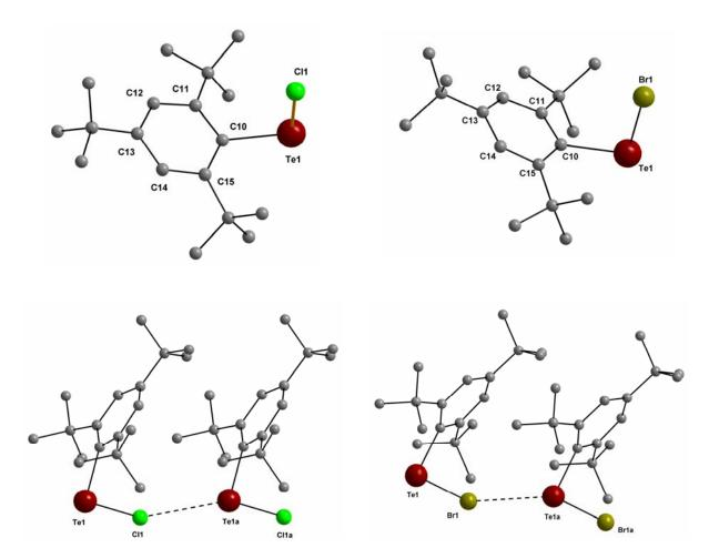
Abbildung 11: Molekülstrukturen von Verbindungen **2** und **3**. Ausgewählte Bindungslängen (Å) und -winkel (°): **2**) Te1-Cl1 2.384(1), Te1-Cl0 2.134(3), Cl1a-Te1 3.677(1), Cl1-Te1-Cl0 93.41(8), Cl1-Cl0-Te1 119.0(2), Cl5-Cl0-Te1 118.8(2), Cl3-Cl0-Te1 160.0(1)); (Symmetriecode: a = 1+x, y, z); (Symmetriecode: a = -1x, y, z). **3**) Te1-Br1 2.532(4), Te1-Cl0 2.1361(18), Br1-Te1a 3.592(3), Cl0-Te1-Br1 93.60(5), Cl5-Cl0-Te1 118.87(13), Cl1-Cl0-Te1 118.98(13); (Symmetriecode: a = 1+x, y, z).
