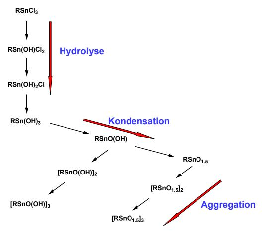
Schema 1: Allgemeines Hydrolyseschema von Monoorganozinntrichloriden RSnCl<sub>3</sub>.
