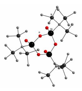
Abbildung 3: Molekülstruktur der Monoorganostannonsäure {[(Me<sub>3</sub>Si)<sub>3</sub>C]<sub>3</sub>Sn(O)OH}<sub>3</sub>.
