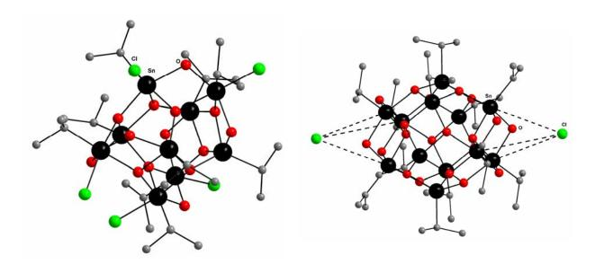
Abbildung 2: Röntgenstrukturen von i-PrSn(O)(OH)Cl<sub>2</sub>·H<sub>2</sub>O, (i-PrSn)<sub>9</sub>O<sub>8</sub>(OH)<sub>6</sub>Cl<sub>5</sub>·6DMSO und [(i-PrSn)<sub>12</sub>O<sub>14</sub>(OH)<sub>6</sub>]Cl<sub>2</sub>.
