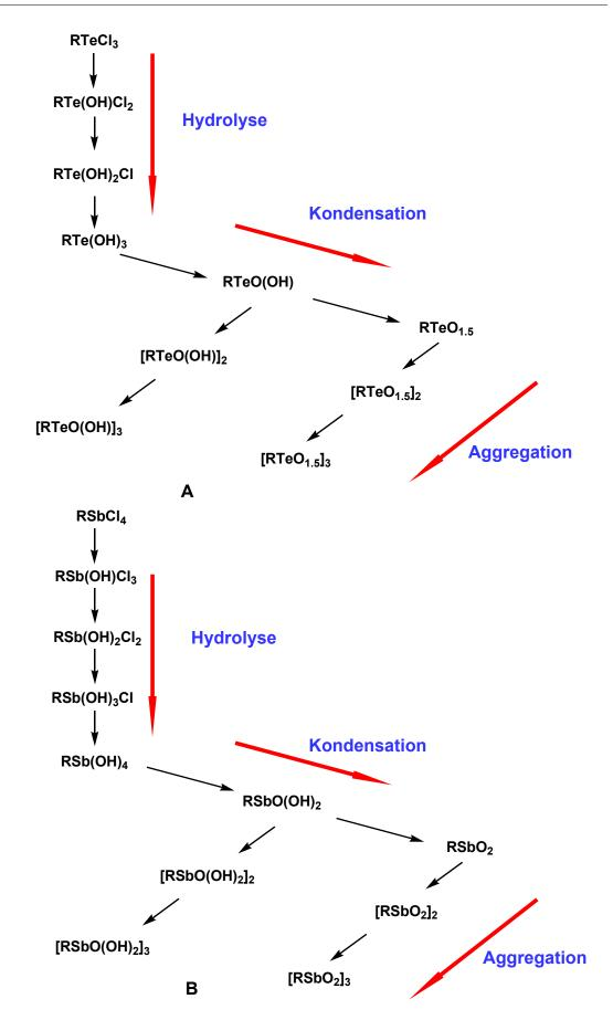
Schema 2: Allgemeines Hydrolyseschema der (A) Monoorganotellur(IV)trichloride und der (B) Monoorganoantimon(V)tetrachloride.
