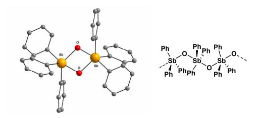
Abbildung 7: Molekülstruktur des dimeren (Ph<sub>3</sub>SbO)<sub>2</sub> und EXAFS-Struktur des polymeren (Ph<sub>3</sub>SbO)<sub>n</sub>.
