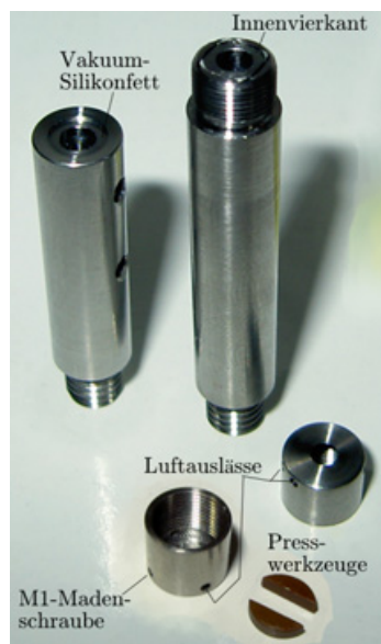
Abbildung 3.8: Photographische Darstellung zweier verwendeter Probenhalter. Links oben: Standard-Probenhalter für Dünnschichtproben zwischen zwei Deckgläschen. Das untere Gläschen wird mit Vakuum-Silikonfett befestigt, während das obere von der Probenflüssigkeit selbst gehalten wird. Bei einer mittels Rotationsbeschichter hergestellten Filmprobe befindet sich diese auf der Oberseite und wird nicht durch ein zweites Deckgläschen abgedeckt. Rechts oben: Probenhalter zum Gelpressen in vertikaler Richtung. Bei aufgeschraubtem Deckel wird das Gel zwischen zwei Deckgläschen von einem Vierkant von unten her aufeinandergepresst. Man beachte die Luftauslässe am Deckel. Der zweite Deckel mit seinen beiden Presswerkzeugen wird auf einen hier nicht abgebildeten Probenhalter geschraubt. Die beiden Presswerkzeuge werden zwischen zwei Deckgläschen mit dem Gel in ihrer Mitte mit Hilfe einer M1-Madenschraube von der Seite her aufeinandergedrückt, so dass das eingeschlossene Gel horizontal gequetscht wird. Auch hier sind Luftauslässe erforderlich.
