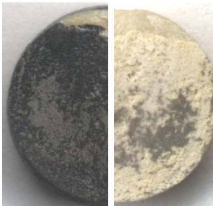
mit Vita-Titankeramik Pastenbonder verblendeter Prüfkörper
