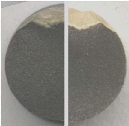
Nebenstehendes Bild zeigte sich bei allen Titanprüfkörpern, welche nur mit Korund sowie Natron-Feldspat abgestrahlt wurden, ausgenommen Vita-Titan-Keramikverblendung mit Bonder. Die Oberflächen der Prüfkörper zeigen nur Reste der Dentin-Keramikmasse. Der größere Anteil der Bruchfläche wird sowohl auf der Titan- als auch auf der Keramikseite von der makroskopisch gleichmäßigen grauen Titan-Oxid-Schicht eingenommen.
