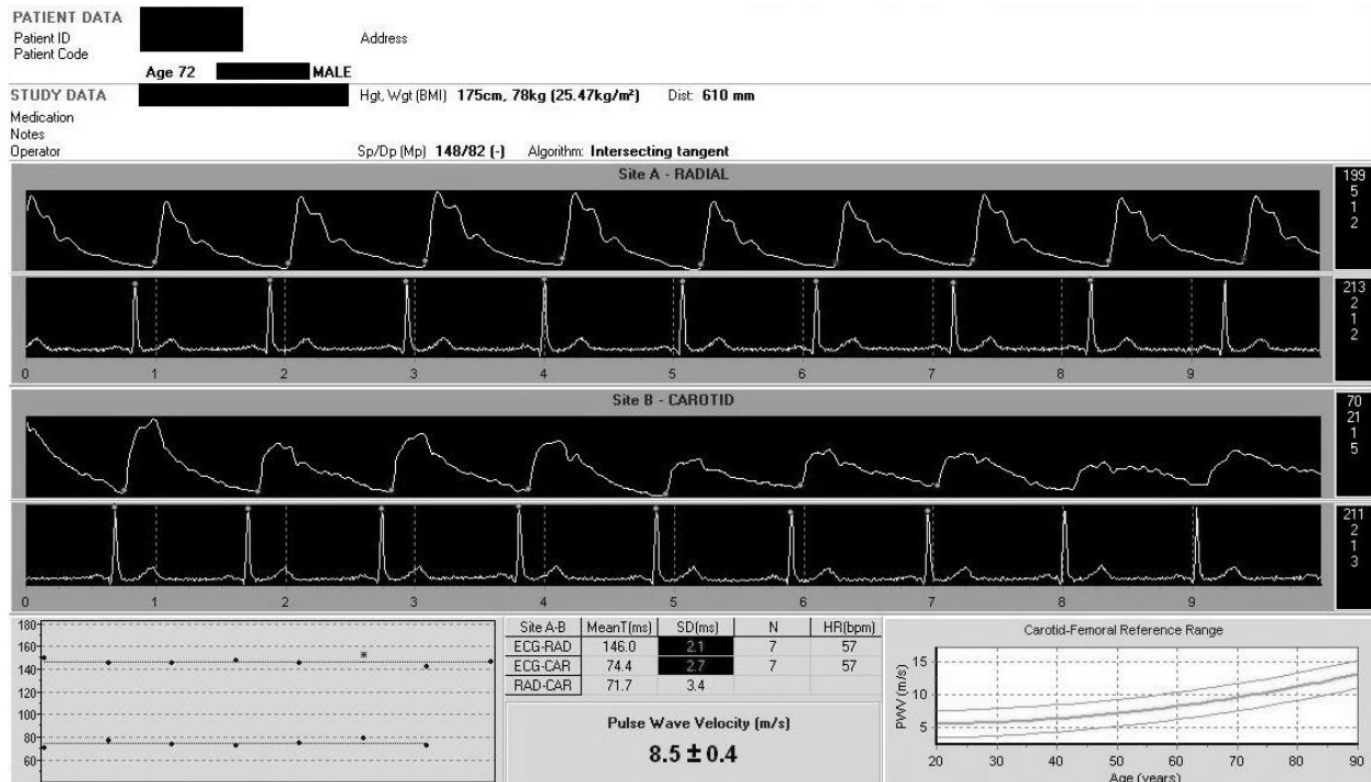
Abbildung 5: Ergebnis der PWV-Berechnung durch das SphygmoCor-System. Nach Aufzeichnung der Pulswellen über Arteria radialis und Arteria carotis für jeweils 12 Sekunden wird mithilfe des simultan aufgezeichneten Elektrokardiogramms die Pulslaufzeit bestimmt und unter Einbeziehung der manuell eingegebenen Distanzen die Pulswellengeschwindigkeit berechnet.
