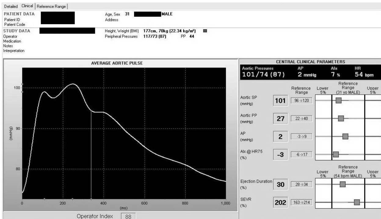
Abbildung 4: Graphische Darstellung der Pulswellenanalyse durch die SphygmoCor-Software. Die links abgebildete aortale Druckkurve wird aus den über einen Zeitraum von 12 Sekunden über der Arteria radialis abgeleiteten Pulswellen ermittelt. Auf der rechten Seite sind die relevanten klinischen Parameter der ermittelten aortalen Pulswelle in Zahlen dargestellt.
