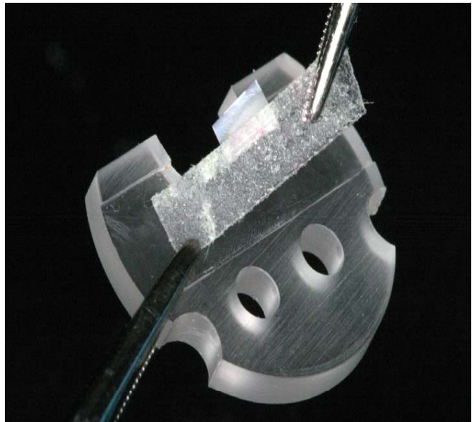
Abb. 7: Mikrohalter mit Probenfixation vor mikroradiografischer Fotografie.
