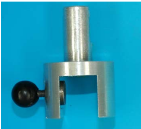
Abb. 2: u-förmige Halterung für die Knochenstücke
