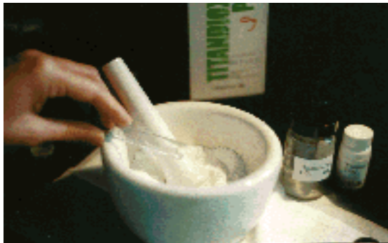
Abbildung 5.18: Vorbereiten einer P25 TiO 2 Suspension
