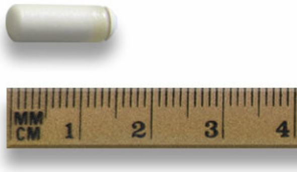
Abb. 3.2: Osmotische Minipumpe der Firma Alzet® ( www.alzet.com ) im Größenvergleich mit einem Lineal (Foto: Grit Ehlert). Die Außenwand der Pumpe ist semipermeabel, so dass infolge der osmotischen Druckdifferenz Gewebsflüssigkeit eindiffundiert. Der Flüssigkeitsstrom deformiert eine elastische Blase, die mit der zu applizierenden Flüssigkeit gefüllt ist. Der Flüssigkeitsausstrom kann durch eine außen aufgebrachte Steuermembran oder ein Regulierungselement an der Austrittsöffnung variiert werden, so dass eine kontinuierliche Wirkstofffreisetzung erfolgt (Nürnberg et al., 1991).
