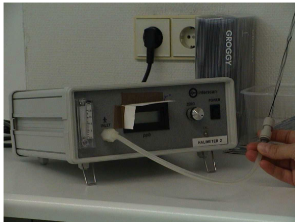
Abb. 2-6: Halimeter mit Sichtblende der Firma Interscan Corporation (Chatsworth, CA., USA).
