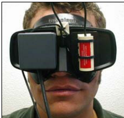
Abbildung 13: Korrekt angelegte Maske mit Infrarot-Miniaturkamera (links) und Winkelgeschwindigkeitsmesser (rechts).
