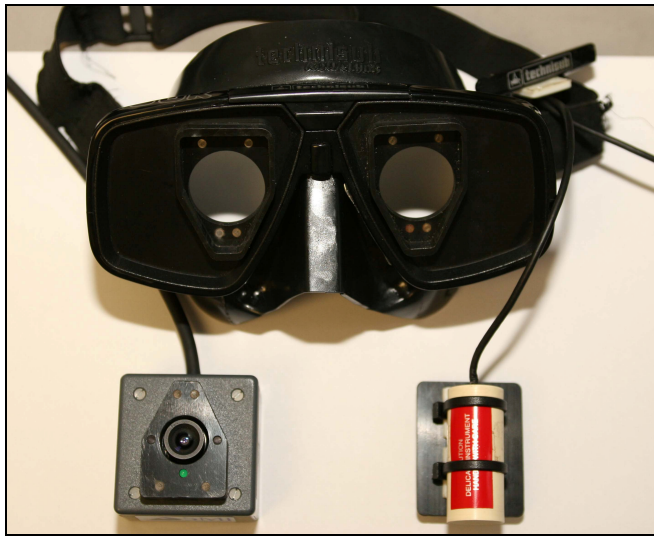
Abbildung 15: Maske zerlegt in ihre einzelnen Komponenten. Die Infrarot-Miniaturkamera befindet sich links und der Winkelgeschwindigkeitsmesser rechts.
