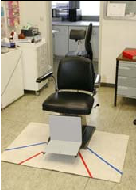
Abbildung 18: Modifizierter HNO-Untersuchungsstuhl in Vorbereitung einer manuellen Drehpendelprüfung. Fußstütze und Winkelschablone sind dem Stuhl ergänzt worden.
