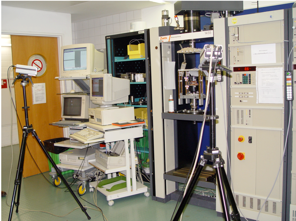
Abbildung 4: Überblick über den Testaufbau. Im Vordergrund auf Stativen die Infrarotkameras des optischen Bewegungsanalysesystems, rechts im Hintergrund die Materialprüfmaschine „Zwick“ mit eingebautem Wirbelsäulenprüfstand, links im Hintergrund die Steuerungsrechner für das Bewegungsanalysesystem und die Materialprüfmaschine.
