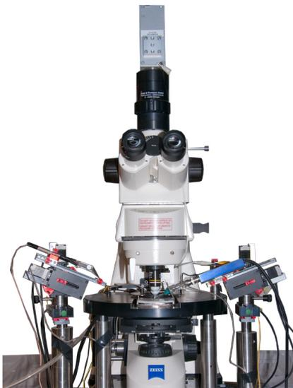
Abbildung 7: Slicesetup mit Vorverstärker (rechts), Stimulationselektrode (links), Brücke, Kamera und aufrechtem Mikroskop
