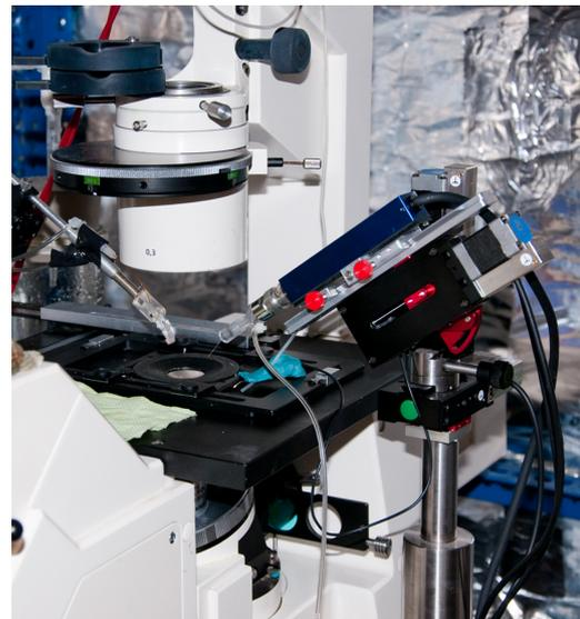
Abbildung 8: Kultursetup mit Kammer, Vorverstärker und inversem Mikroskop
