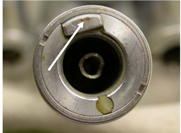
Abb.3.4.: Verschmutzungen an der Kupplung zum Mikromotor, Bereich 4 in Abb.3.7
