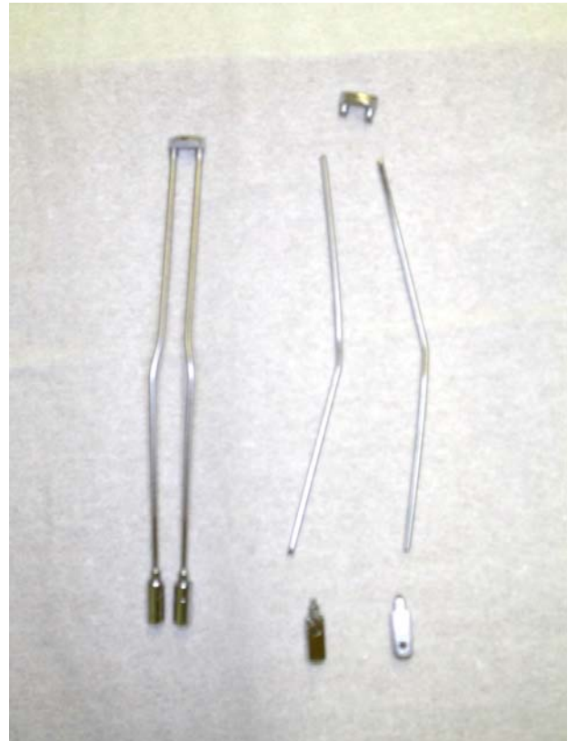
Abb. 2.4.: Spraykanäle, rechts getrennt
