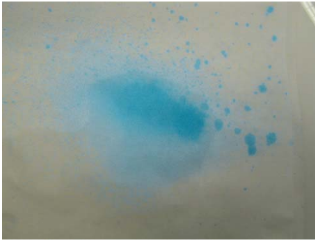
Abb. 1.26: Zuvor eingesogene Sprayflüssigkeit auf Filterpapier
