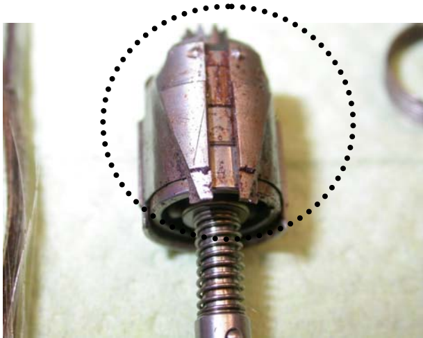
Abb.3.5.: Verschmutzungen an der Getriebe- kupplung (innen), Bereich 5 in Abb.3.7
