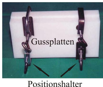
Um ein Verrutschen zu verhindern, wurden die zwei Gussplatten exakt positioniert und verschraubt. Anschließend wurde die flüssige Wolframlegierung eingefüllt.
