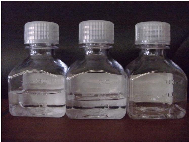
Abbildung 5.3-5: Makroskopische Aufnahme der Wasser-Proben, die in PC-Flaschen gelagert wurden. Links: bei 4°C, Mitte: bei Raumtemperatur, Rechts: bei 40°C
