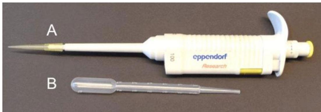
**Abbildung 4.1-1: Instrumente zur Probenahme. A: Eppendorf-Pipette, B: Pasteur-Pipette**
