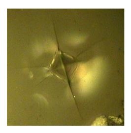
Abb. 6.8.: Härteeindruck, von dem fünf Risse ausgehen
