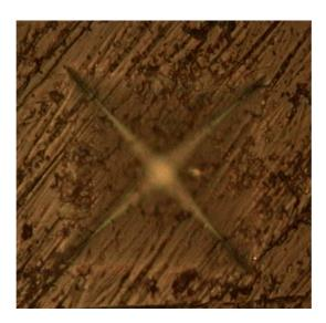
Abb. 6.12.: Schwierigkeit der Erzeugung sichtbarer Risse auf schlecht polierbaren Oxidkeramiken
