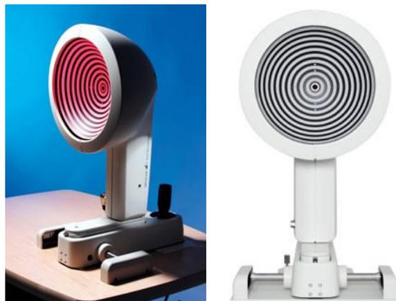
Abb. 2-11: Meßkopf eines Videokeratoskops mit Placido Ringen (Keratograph von Oculus)
