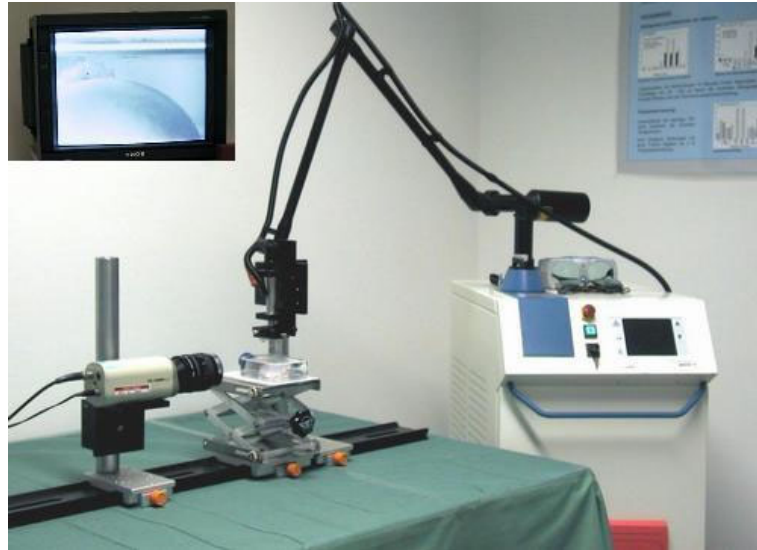
Abb. 63: Messplatz für kontrollierte Abtragexperimente. Rechts der Er:YAG-Laser (Asklepion), oben ein Monitor, auf dem mittels einer Videokamera die Faseranordnung etwa zehnfach vergrößert dargestellt werden konnte.
