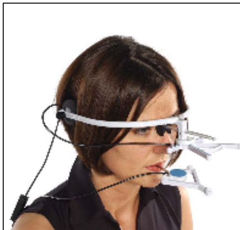
Abbildung 4: WinJaw Messapparatur beispielhaft am Kopf angebracht, aus WinJaw 10.4 for Windows Operating Instructions 02/2002 © zebris 05/2004
