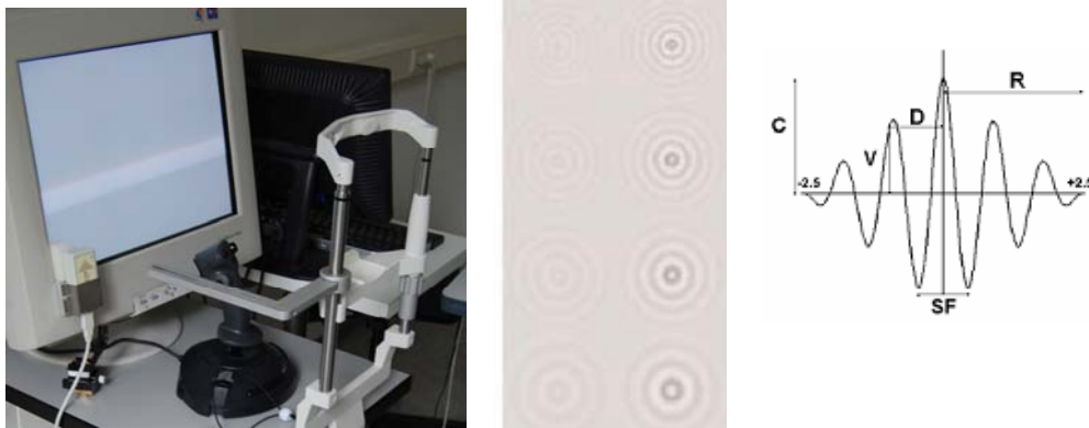
Abbildung 25: Pulsar-Perimeter-Aufbau der FA Haag Streit International (li.), Bildschirmanzeige (mittig) und Charakteristik der Teststimuli (re.)
